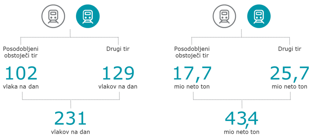
Slika 48: Prepustna zmogljivost odseka Divača–Koper po izvedbi projekta
